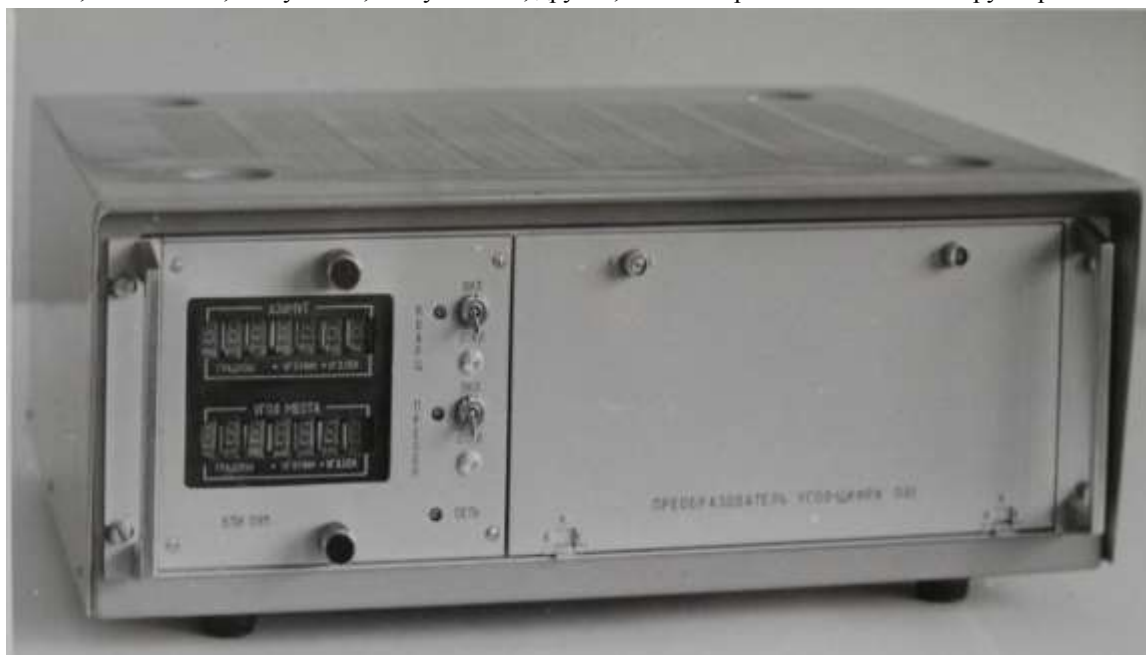
Фото 17. Преобразователь сигналов СКВТ – цифра, на две координаты СПУ - 5.
