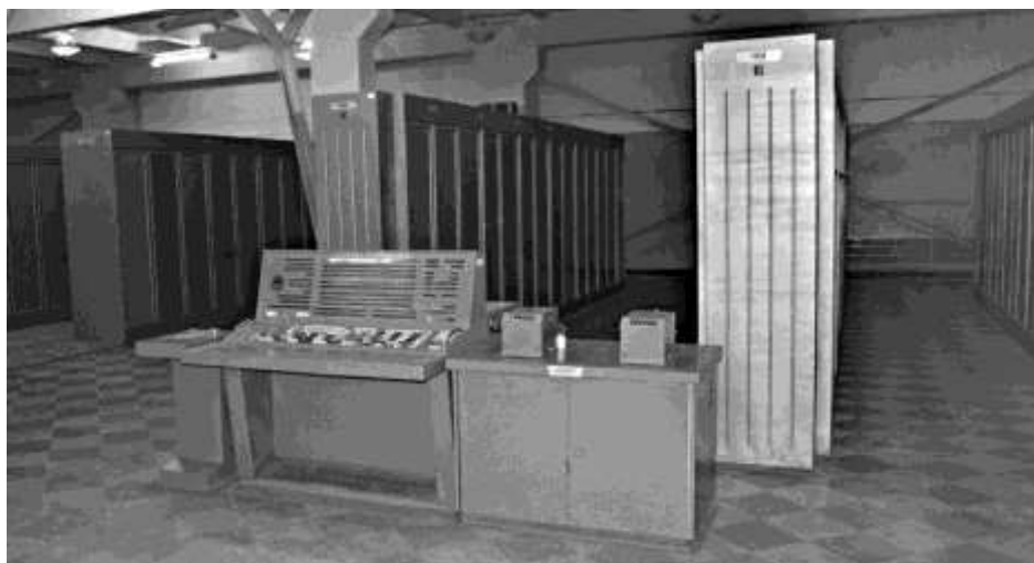
Рис. 11. ЭВМ "К340А" - 20 шкафов в три ряда, инженерный пульт и регистратор – два принтера
